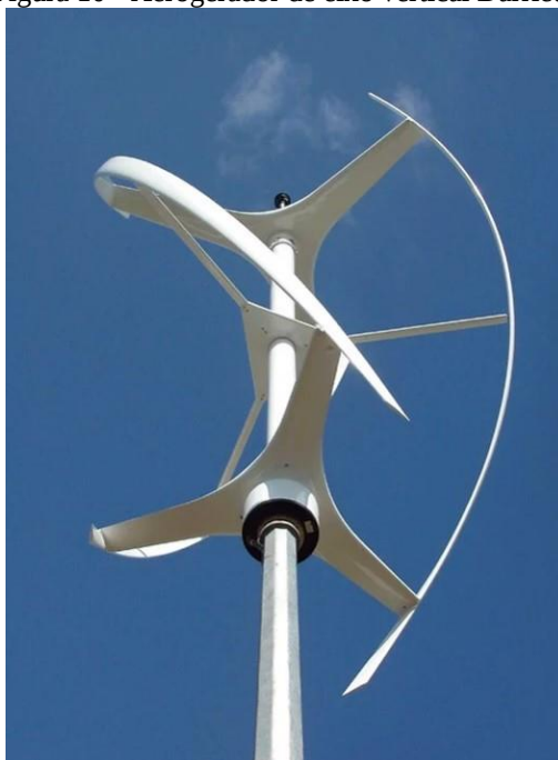
Figura 10 - Aerogerador de eixo vertical Darrieus
