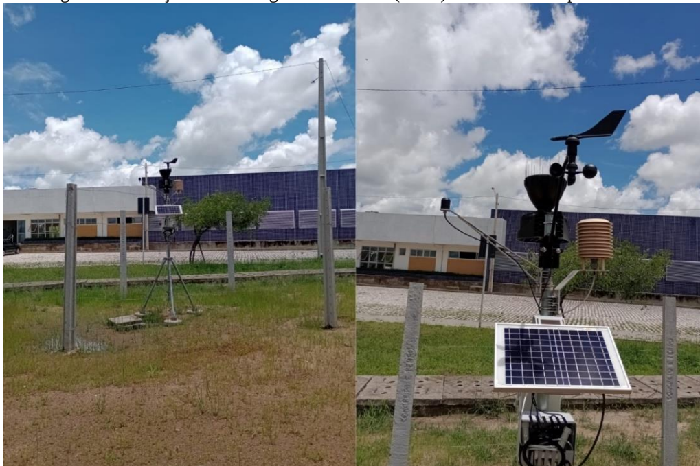
Figura 17 - Estação Meteorológica Automática (EMA) - UFERSA campus Caraúbas
