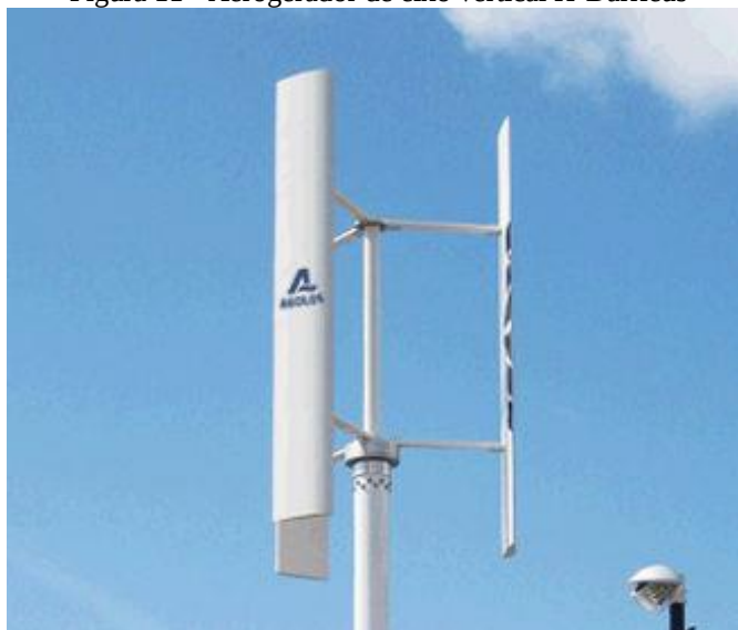
Figura 11 - Aerogerador de eixo vertical H-Darrieus
