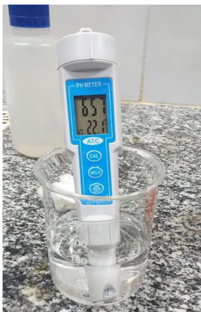
Figura 29: Verificação do pH da água
