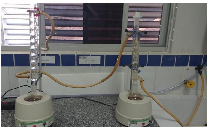
Figura 25: Equipamento utilizado para que o material permanecesse em refluxo
