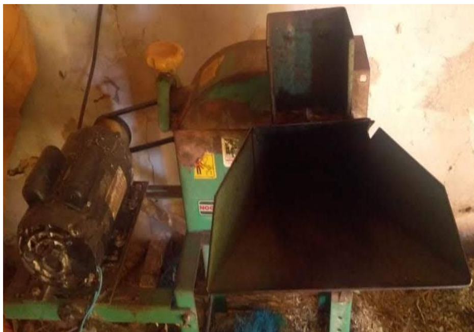
Figura 16: Forrageira elétrica utilizada para processamento do coco
