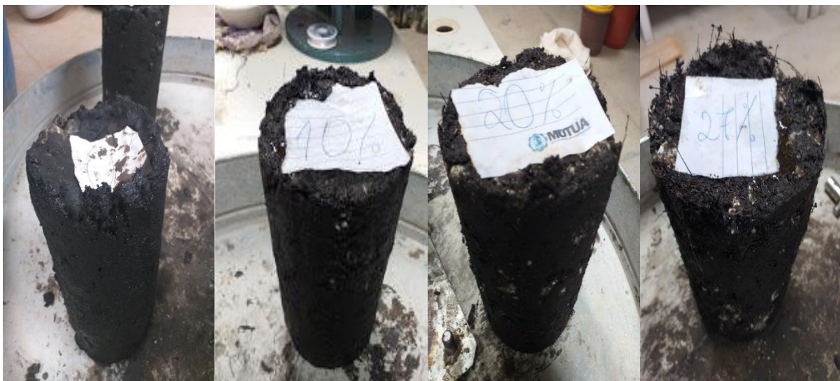
Figura 42: Corpos de prova após desmolde
