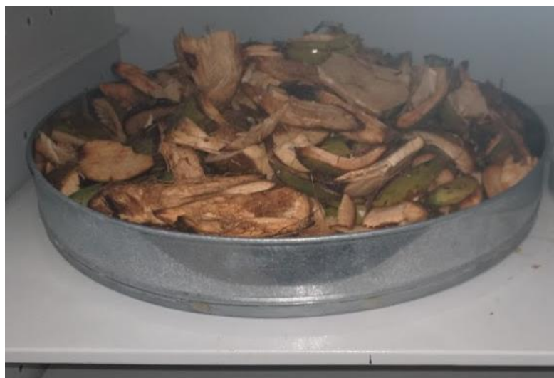
Figura 15: Cascas do coco verde em secagem na estufa a 105 °C
