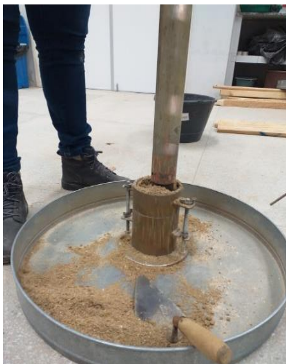
Figura 37: Compactação da camada de fibra com auxílio da haste
