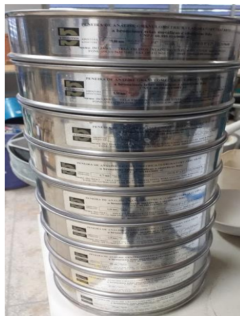
Figura 34: Série de peneiras utilizadas no ensaio de granulometria
