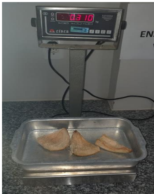
Figura 17: Pesagem do conjunto amostra-fôrma úmido
