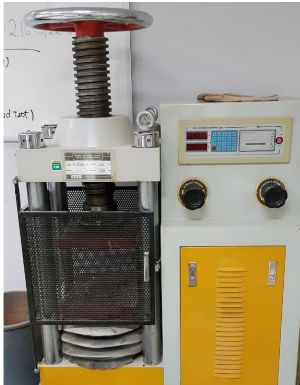
Figura 39: Prensa utilizada para ruptura dos corpos de prova
