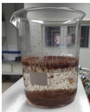
Figura 24: Amostra após decorrida as 24 horas em descanso no ácido sulfúrico
