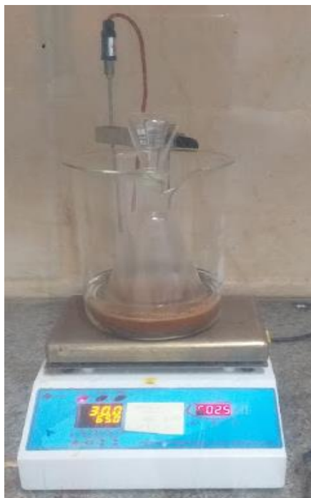
Figura 31: Procedimento para extração da holocelulose
