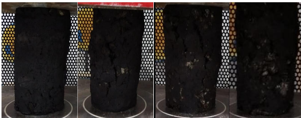
Figura 43: Corpos de prova após ruptura
