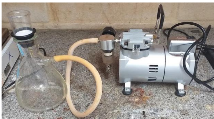
Figura 32: Conjunto utilizado para filtração da holocelulose
