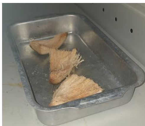
Figura 18: Amostra do coco úmido em secagem na estufa a 105 °C
