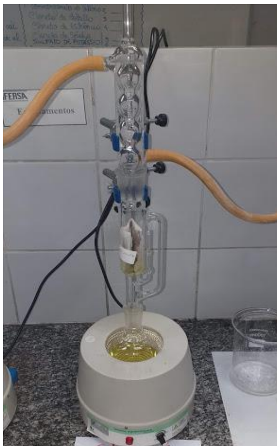
Figura 23: Sistema com Soxhlet utilizado para extração
