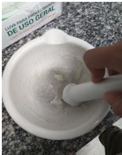
Figura 33: Trituração da holocelulose
