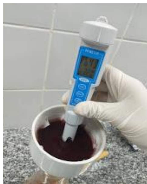
Figura 30: Verificação do pH do precipitado
