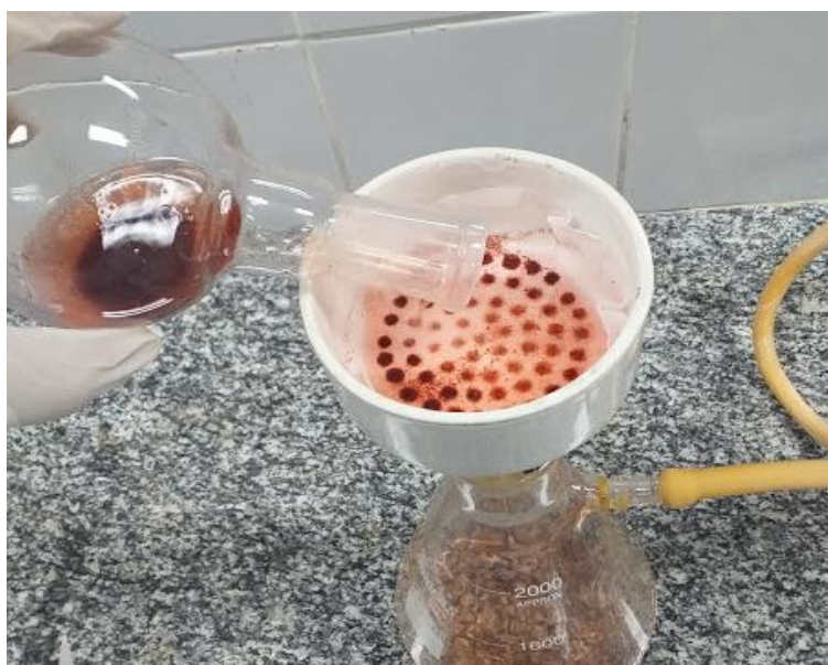
Figura 27: Transferência do conteúdo do balão para o conjunto de filtração
