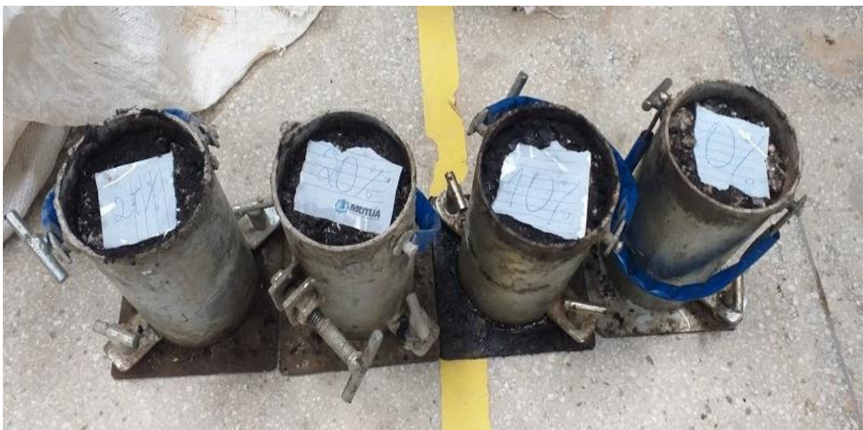
Figura 41: Corpos de prova no instante imediato após moldagem
