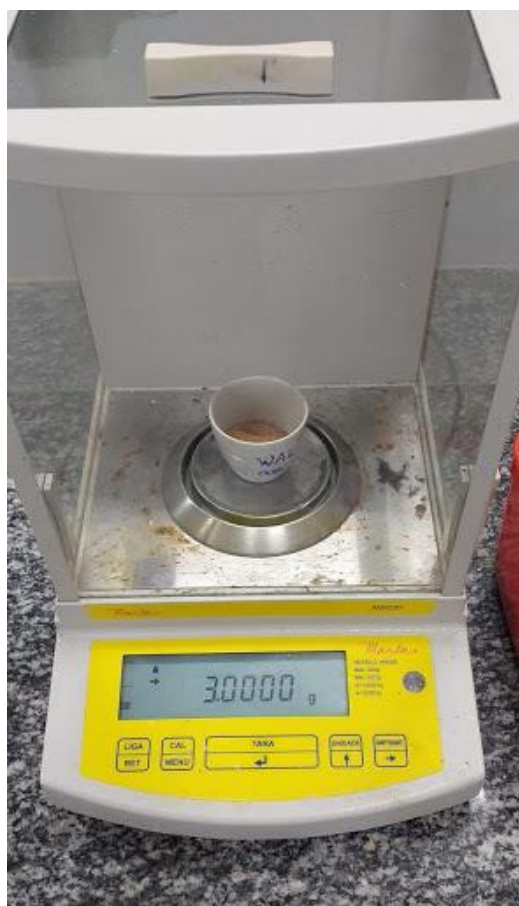
Figura 19: Pesagem da amostra utilizada para a análise do teor de cinzas
