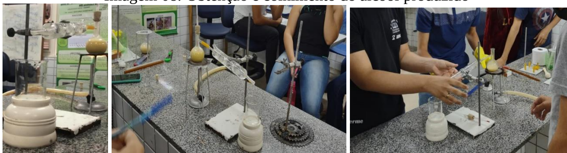
Imagem 08: Obtenção e colhimento do álcool produzido
