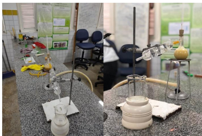
Imagem 07: Montagem do sistema de destilação simples.
