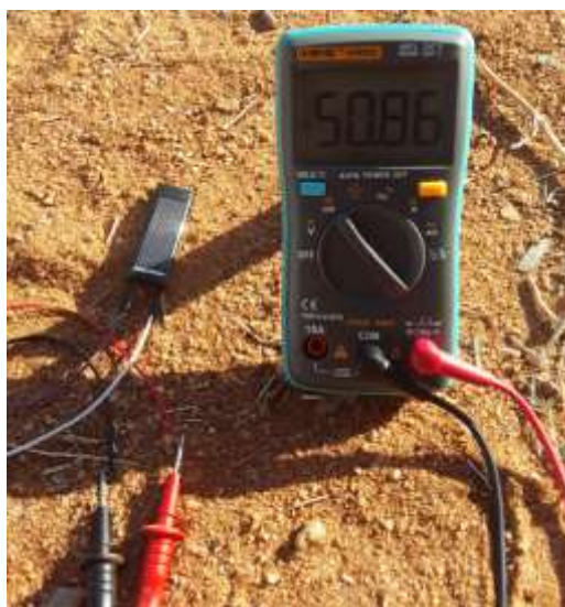
Figura 24: Testes com a célula fotovoltaica
