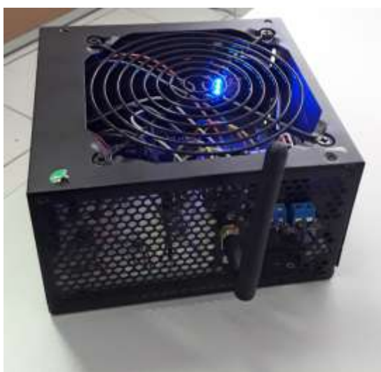
Figura 51: Dispositivo para monitoramento de um painel fotovoltaico
