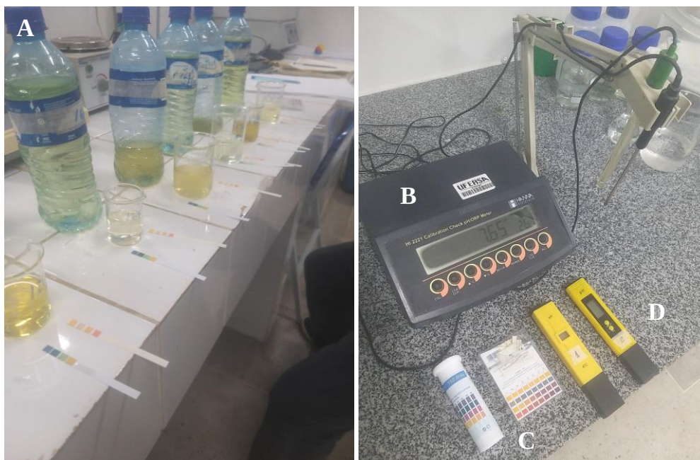
Figura 3. Amostragem e equipamentos utilizados durante o experimento: (A) mensuração do pH urinário das amostras usando fitas de pH; (B) pHmetro analítico de bancada; (C) duas marcas de fitas de pH e (D) dois modelos de pHmetros de bolso.
