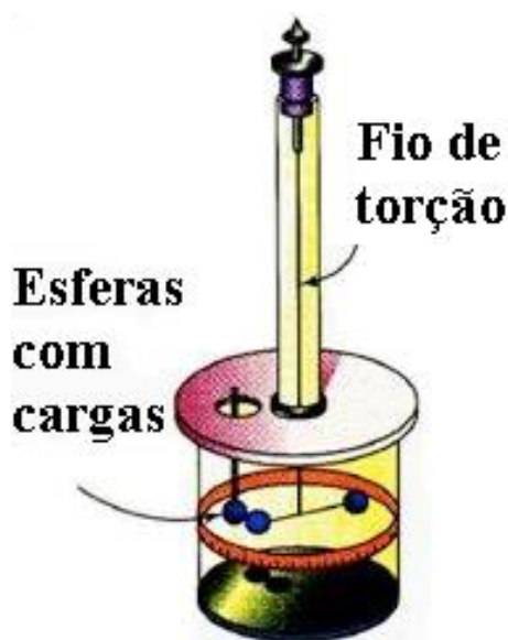
Figura 4 – Balança de torção utilizada por Coulomb para medir a força elétrica entre pequenas cargas.
