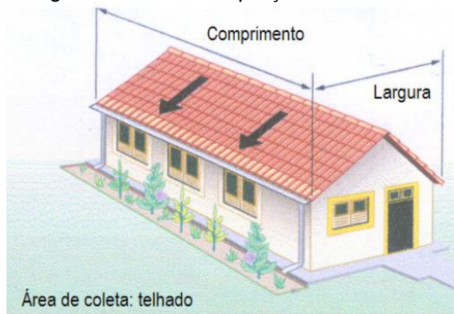
Figura 4- Área de captação em telhados
