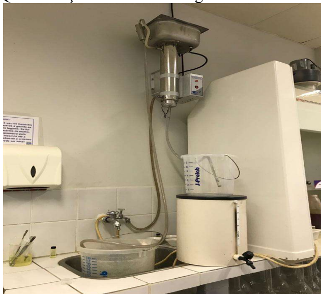
Figura 28: Quantificação do volume de água descartado dos destiladores
