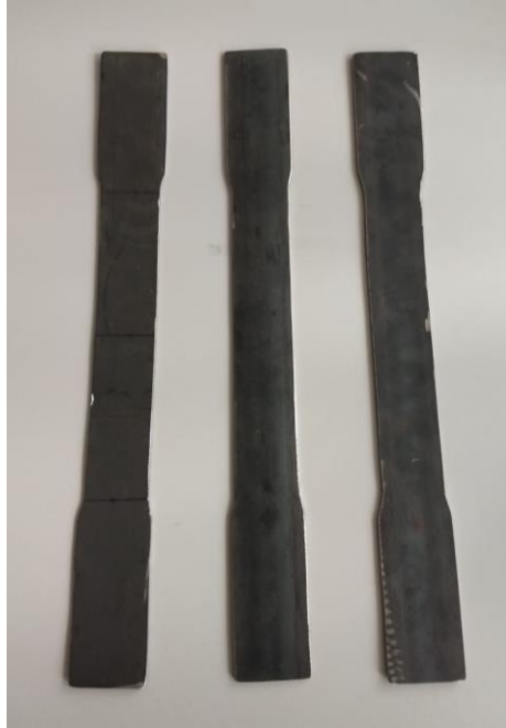
Figura 11 – Corpos de prova para ensaio de tração
