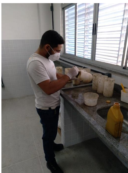
Figura 15: Lubrificação dos corpos de prova.
