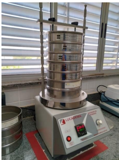
Figura 13: Processo de peneiramento.
