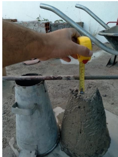
Figura 23: Abatimento dos concretos.
