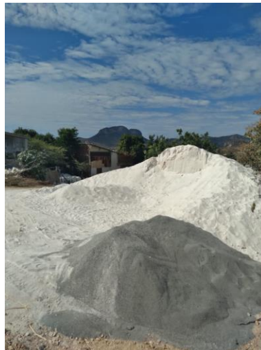
Figura 9: Estocagem de pó de pedra.
