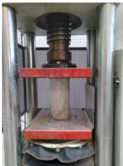
Figura 18: Corpo de prova no ensaio de compressão.
