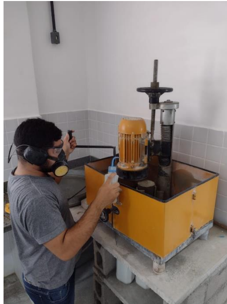
Figura 17: Processo de retificação dos corpos de prova.
