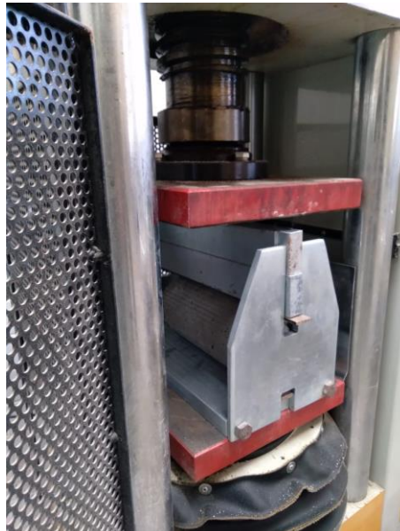
Figura 19: Ensaio de tração por compressão diametral.
