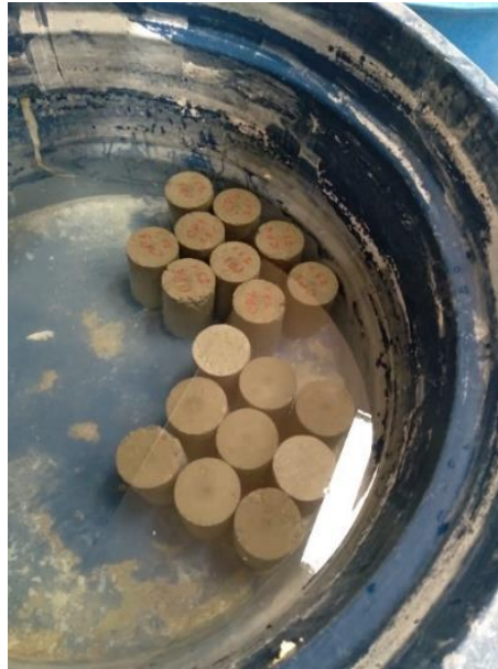
Figura 16: Corpos de prova submersos.
