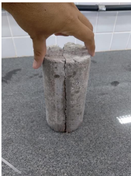
Figura 24: Resultado do ensaio de tração por compressão diametral.
