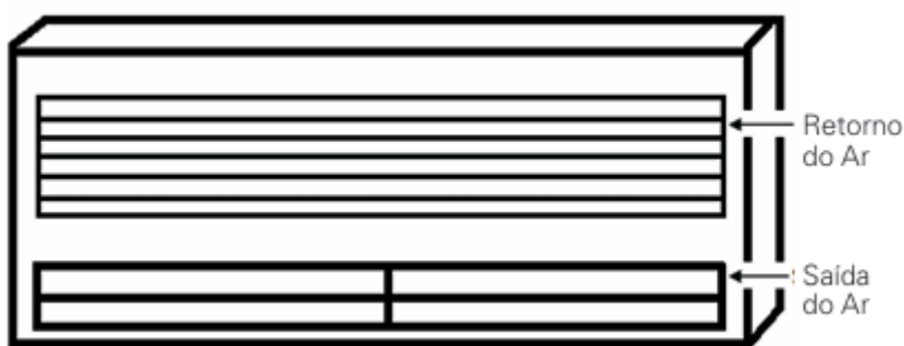
Figura 3 - Exemplo de Unidade Evaporadora de um Ar condicionado do tipo split
