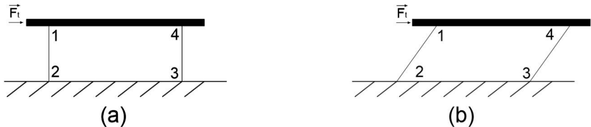
Figura 1.2 Experiência de Placas Paralelas, fixa no interior, submetido à força tangencial \vec{F}_t no superior.
