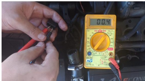
Figura 23. Teste do Sensor de Rotação (Autoria Própria, 2018)
