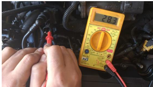
Figura 16. Teste da Válvula do Canister (Autoria Própria, 2018)
