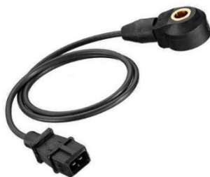
Figura 11. Sensor de Detonação (Autos.culturamix.com, 2018)
