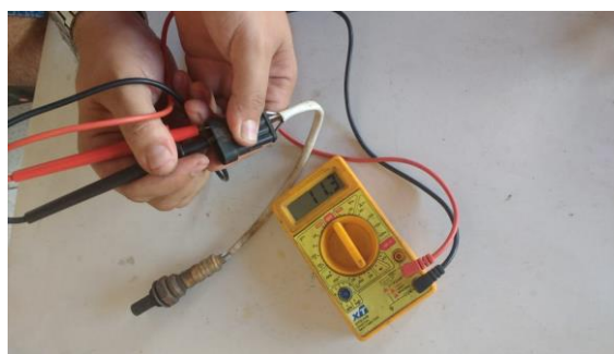
Figura 22. Teste da Resistência de Aquecimento (Autoria Própria, 2018)
