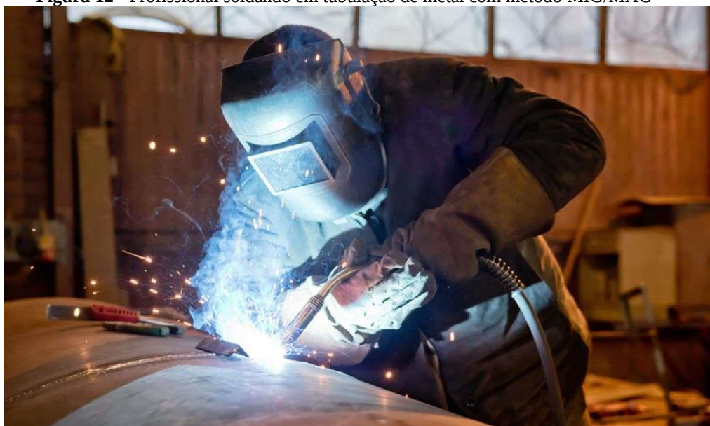
Figura 12 - Profissional soldando em tubulação de metal com método MIG/MAG
