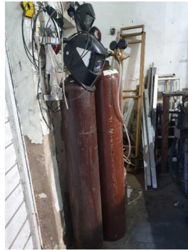
Figura 27 - Gás de proteção
