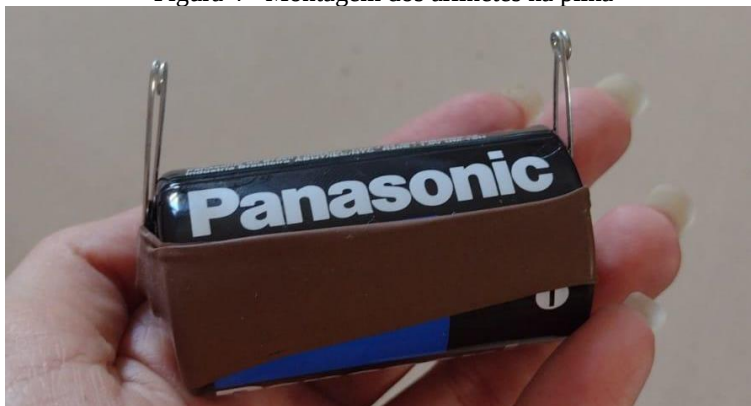
Figura 4 - Montagem dos alfinetes na pilha
