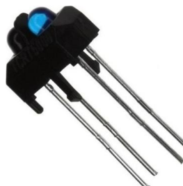
Figura 32: Sensor óptico reflexivo TCRT5000
