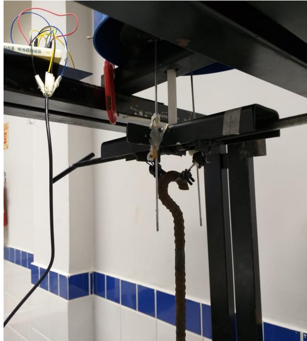
Figura 42: Corpo de prova fixado entre as vigas
