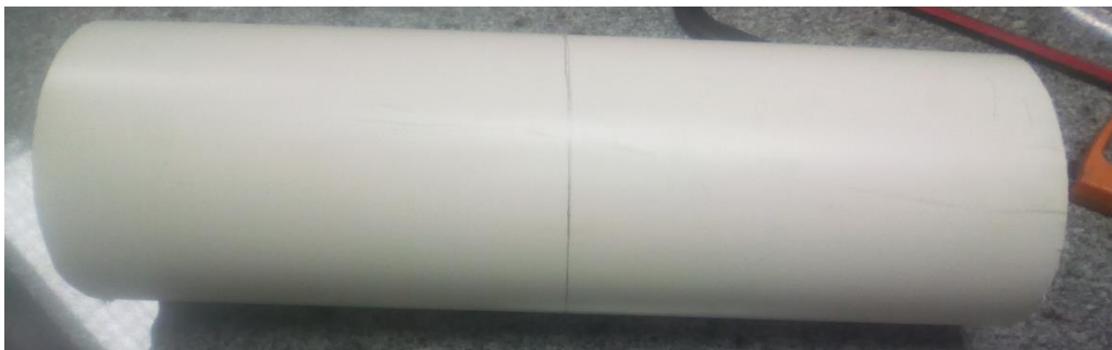
Figura 26: Cano de esgoto em PVC DN 150
