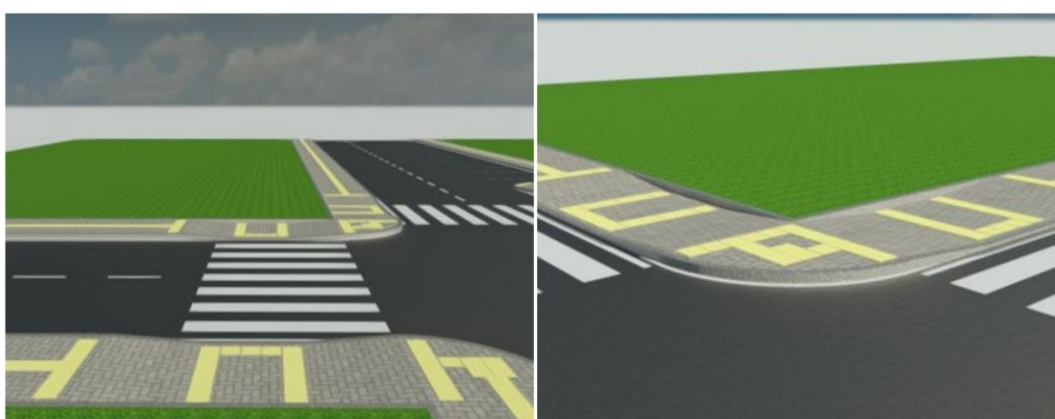
Figura 49 - Rebaixamento de guias para calçadas estreitas.
