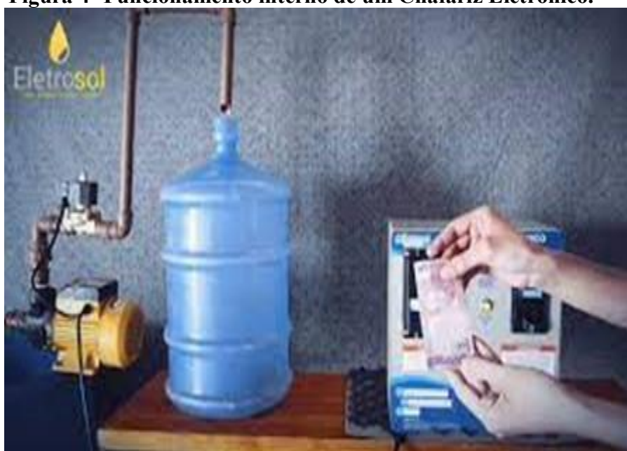
Figura 4- Funcionamento interno de um Chafariz Eletrônico.
