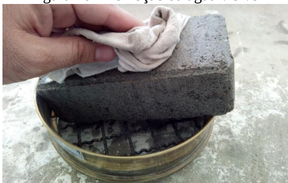
Figura 26 - Remoção da água visível
