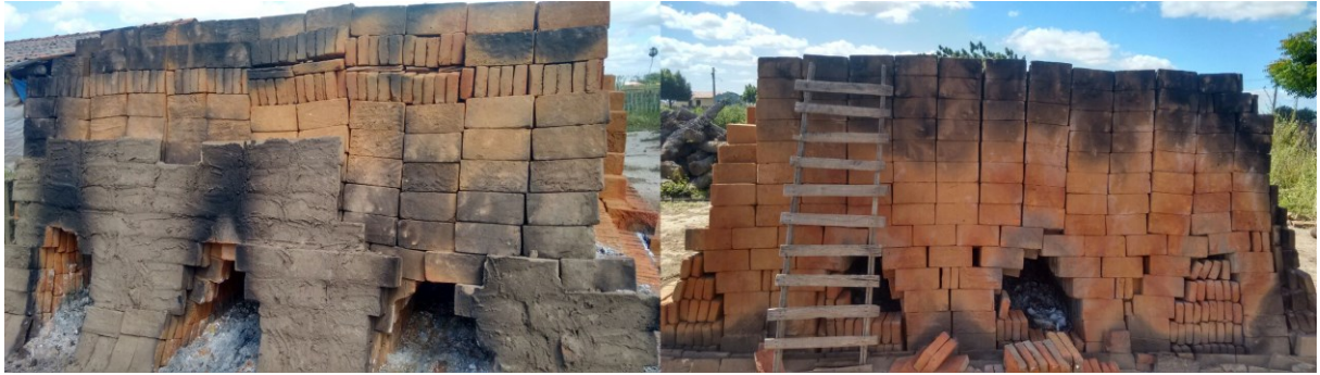
Figura 10 – Forno de meda utilizado no cozimentos dos tijolos.
