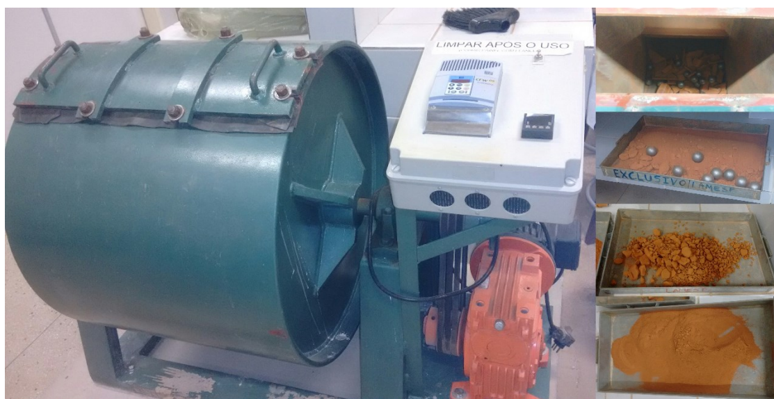
Figura 6 – Moinho usado na fragmentação do chamote – Equipamento de abrasão Los Angeles.
