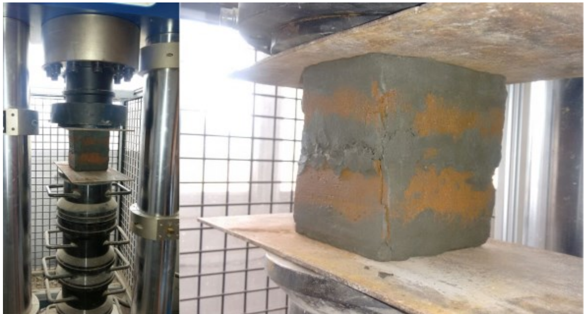
Figura 17 – Amostra de um ensaio de resistência à compressão.
