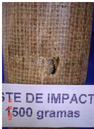
Figura 10: Corpo-de-prova tubular do compósito de fibra de juta/poliéster com impacto de 1500 gramas.
