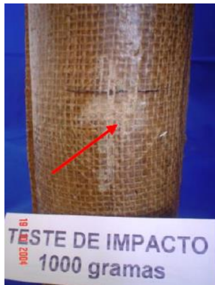
Figura 9: Corpo-de-prova tubular do compósito de fibra de juta/poliéster com impacto de 1000 gramas
