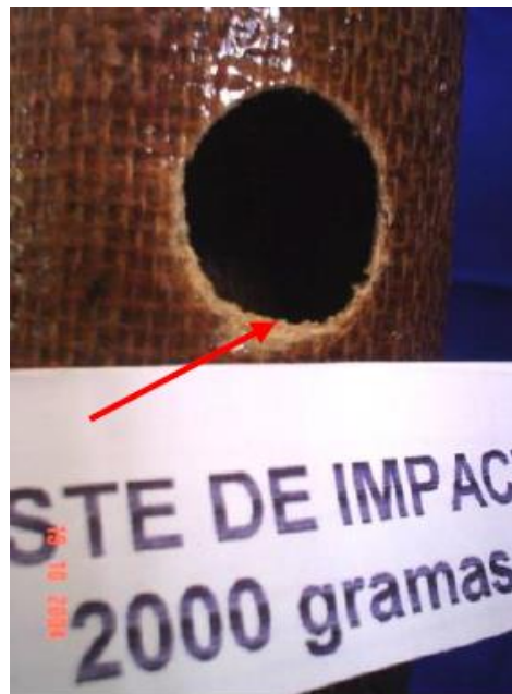
Figura 11: Corpo-de-prova tubular do compósito de fibra de juta/poliéster com impacto de 2000 gramas
