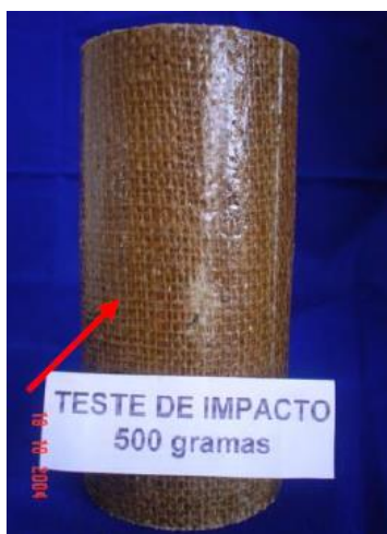
Figura 8: Corpo-de-prova tubular do compósito de fibra de juta/poliéster com impacto de 500 gramas
