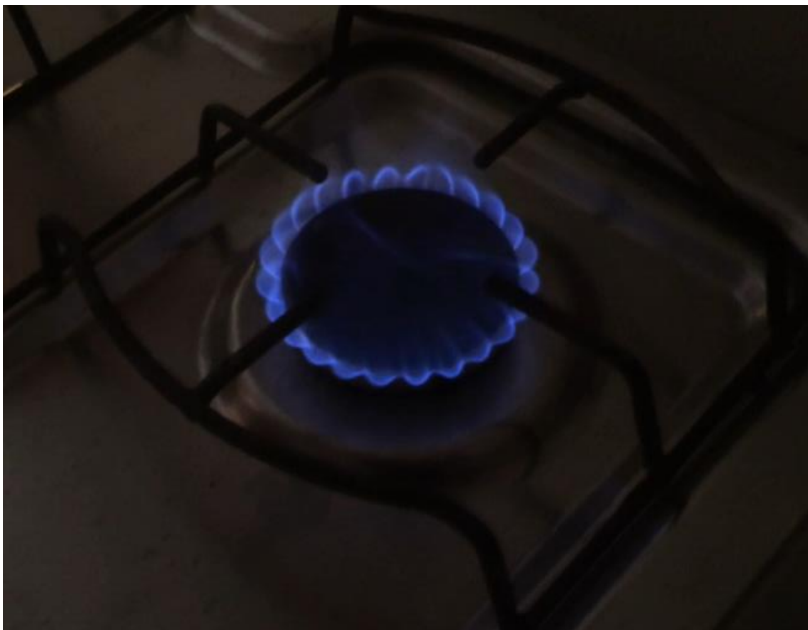
Figura 23: chama proveniente do biogás
