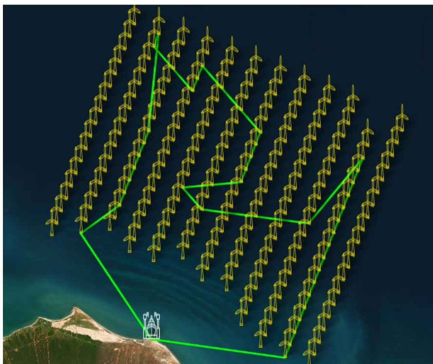
FIGURA A3. Exemplo de melhor trajeto encontrado para Problema 3 com 15 aerogeradores com algoritmo OCF (autoria própria).
