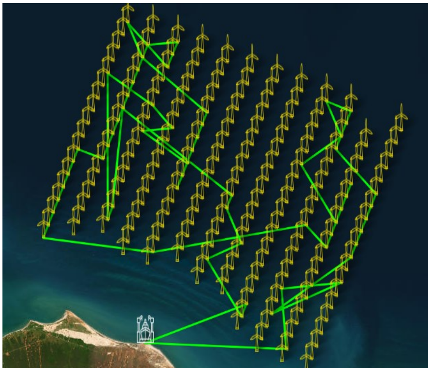
FIGURA 3. Exemplo de melhor trajeto encontrado para Problema 1 com 40 aerogeradores com algoritmo OCF (autoria própria).
