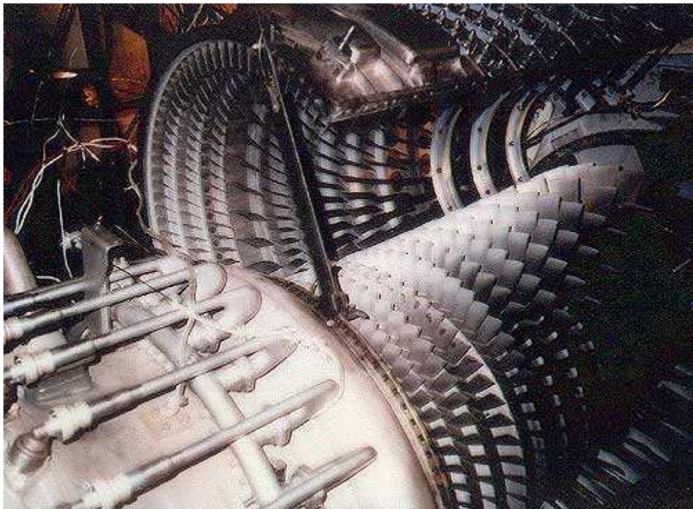
Figura 18- Compressor de uma turbina a gás
