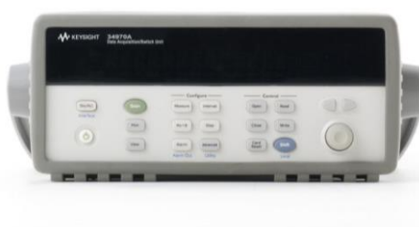
Figura 14 - DAQ Keysight 34972A.
