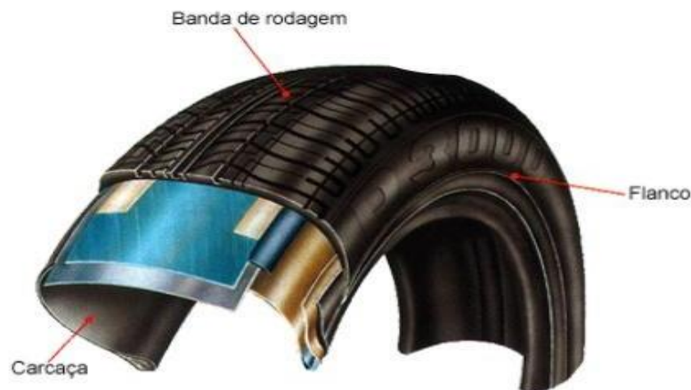
Figura 7: Constituintes do pneu
