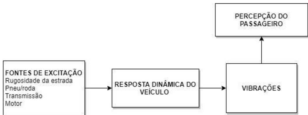
Figura 11: Fluxograma da dinâmica vertical.
