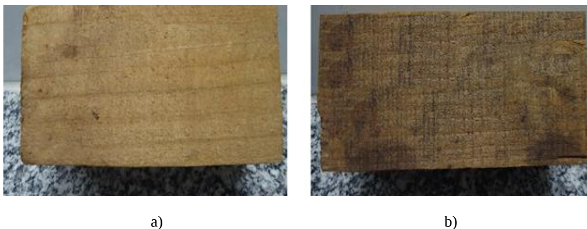
Figura 15: Revelação dos vestígios na madeira utilizando a solução de \text{AgNO}_3 . Na imagem b) o pó foi utilizado na tentativa de tornar visível as digitais. Fonte: Acervo Pessoal.
