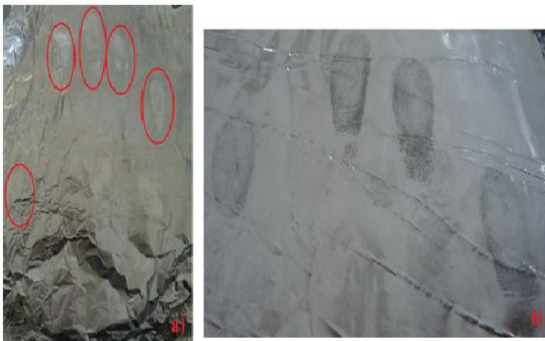
Figura 16: Revelação dos vestígios no papel alumínio utilizando a solução de \text{AgNO}_3 . Na imagem b) o pó foi utilizado para tornar mais visível uma das amostras. Fonte: Acervo Pessoal.
