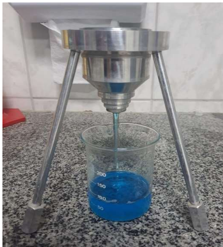
Figura 3 - Medição da viscosidade de amostra com o uso do copo Ford 4.
