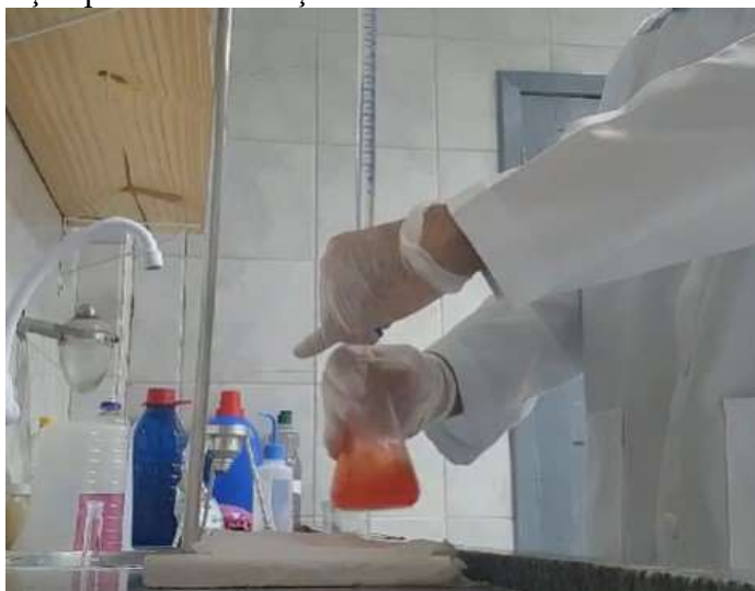
Figura 5 - Titulação para determinação da alcalinidade em amostra de sabão.
