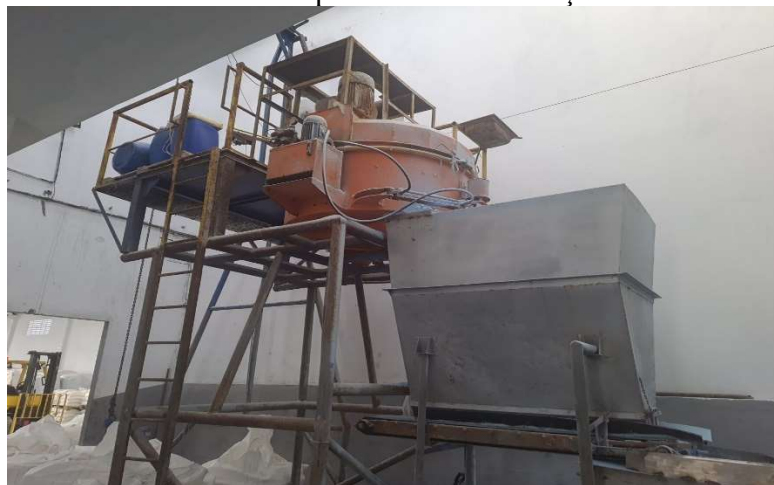
Figura 7 - Misturador utilizado no processo de fabricação do sabão em pó.
