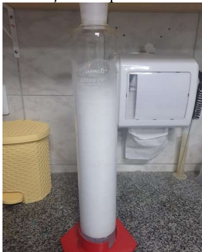
Figura 2 - Análise da formação de espuma em amostra de sabão.
