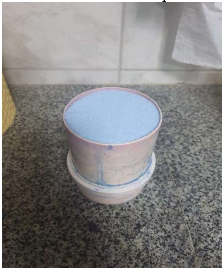
Figura 4 - Determinação da densidade do sabão em pó utilizando um copo de 1L.
