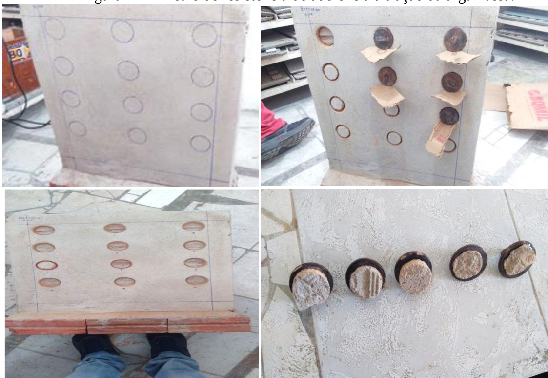
Figura 14 – Ensaio de resistência de aderência a tração da argamassa.
