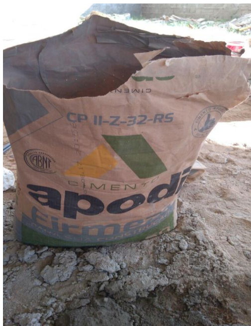
Figura 7 – Cimento utilizado na produção da argamassa.
