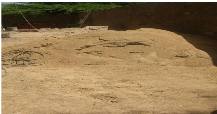
Figura 8 – Agregado miúdo utilizado na produção da argamassa.
