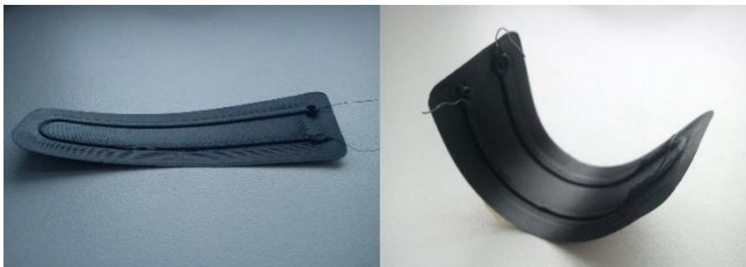
Figura 18 – Atuador fabricado em impressora 3D com utilização de fios Flexinol.
