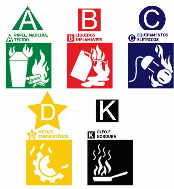
Figura 4 – Classes de incêndio relacionadas a cada extintor.
