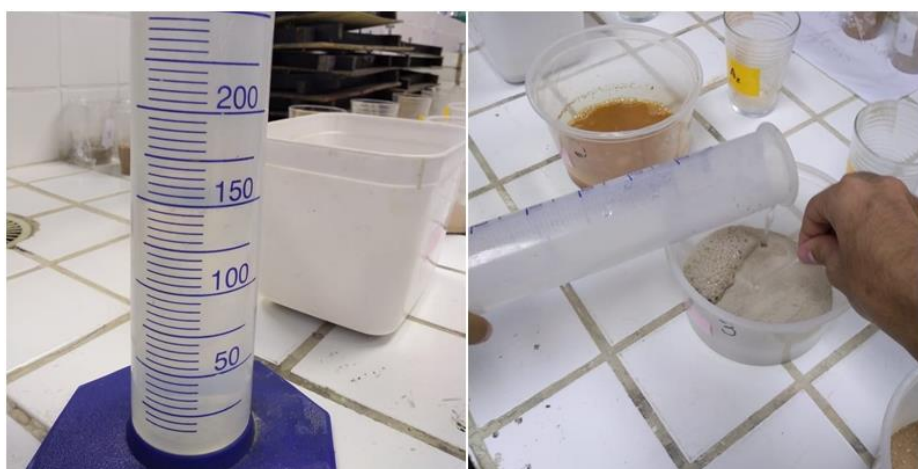
Figura 14. Proveta com 150ml de ácido clorídrico e o momento inicial da reação química
