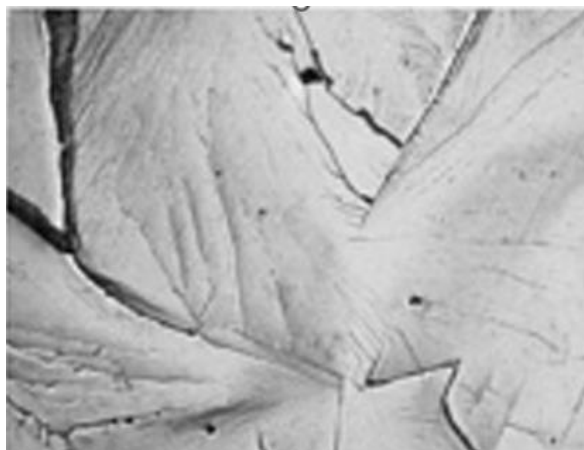
Figura 3: Facetas de clivagem em grãos de ferrita. [6].
