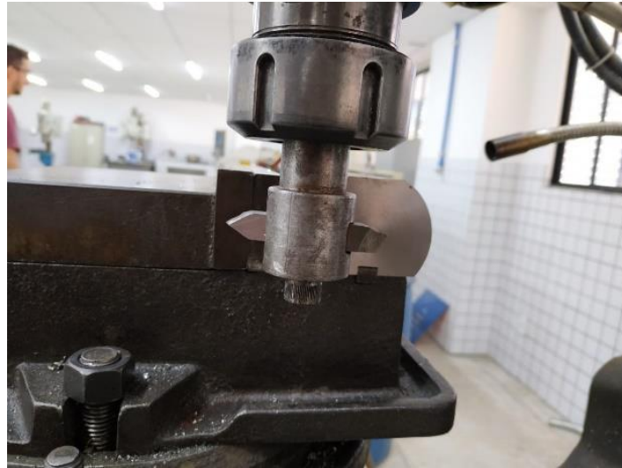
Figura 2: Ferramenta utilizada para a usinagem do entalhe (Autoria própria)
