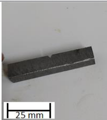
Figura 4: corpo de prova finalizado com dimensões 10x10x55mm (Autoria própria)
