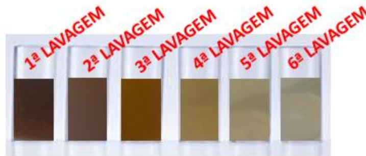
Figura 11: Água residual proveniente das lavagens do material.
