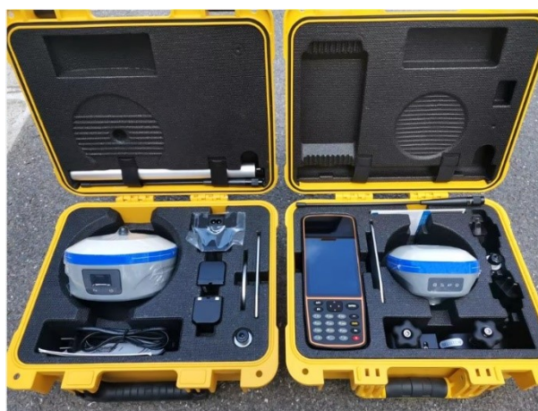
Figura 3. Maletas com os equipamentos de GPS RTK CHC i73. (Fonte: Shanghai Apeksstool Optoelectronic Technology Co. ).
