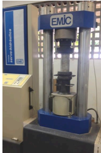
Figura 18: Máquina EMIC SSH300 -utilizada no ensaio de resistência à compressão
