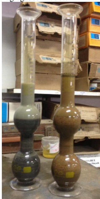
Figura 6: Frascos Chapman com areia natural e pó de pedra durante os ensaios de massa específica dos agregados miúdos.
