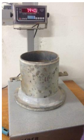
Figura 9: Recipiente utilizado no ensaio de determinação da massa unitária.
