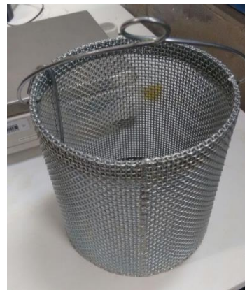
Figura 8: Cesto de arame utilizado no ensaio de determinação da massa específica do agregado graúdo.
