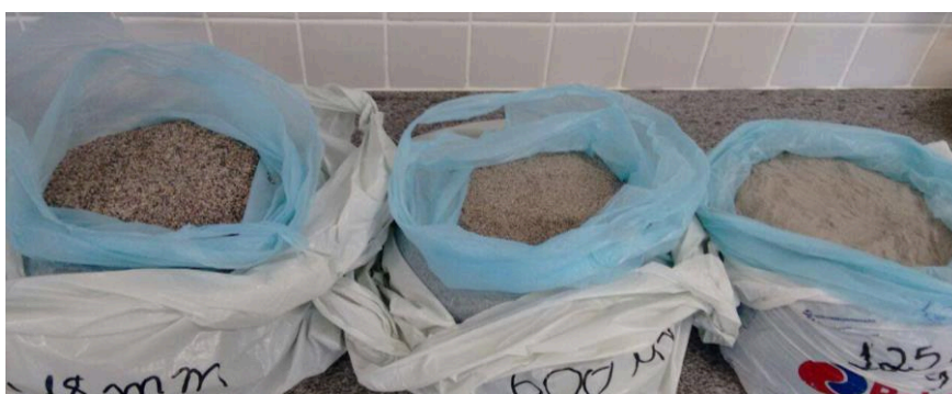
Figura 12: Composição granulométrica do pó de pedra selecionada para compor os traços.
