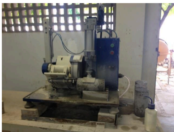
Figura 17: Máquina utilizada no processo de retificação dos corpos-de-prova.
