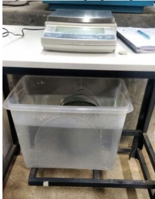
Figura 7: Equipamentos utilizados na determinação da massa específica do agregado graúdo.
