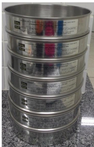
Figura 5: Conjunto de peneiras utilizado no ensaio de composição granulométrica.
