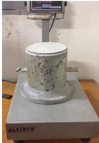
Figura 10: Recipiente- agregado utilizado no ensaio de determinação da massa unitária.
