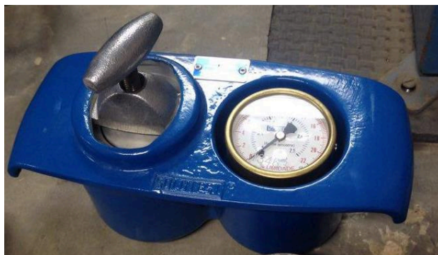
Figura 11: Dispositivo "speedy" utilizado no ensaio de determinação da umidade.
