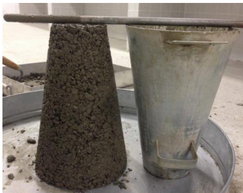
Figura 19: Determinação da consistência do concreto através do abatimento do tronco de cone.
