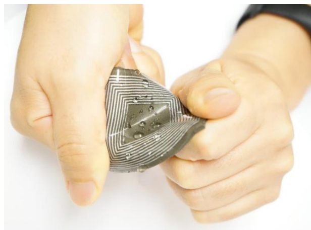
Figura 4 – Gerador bioeletrônico. Fonte: Jun Chen/UCLA (2021).
