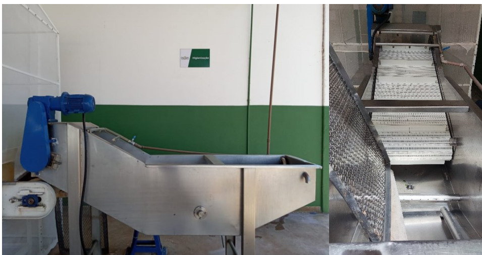
Figura 2 - Tanque de lavagem e sanitização.
