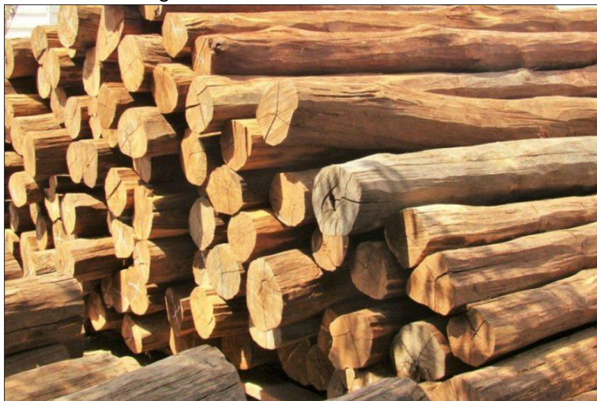
Figura 3.12 - Estacas de madeira
