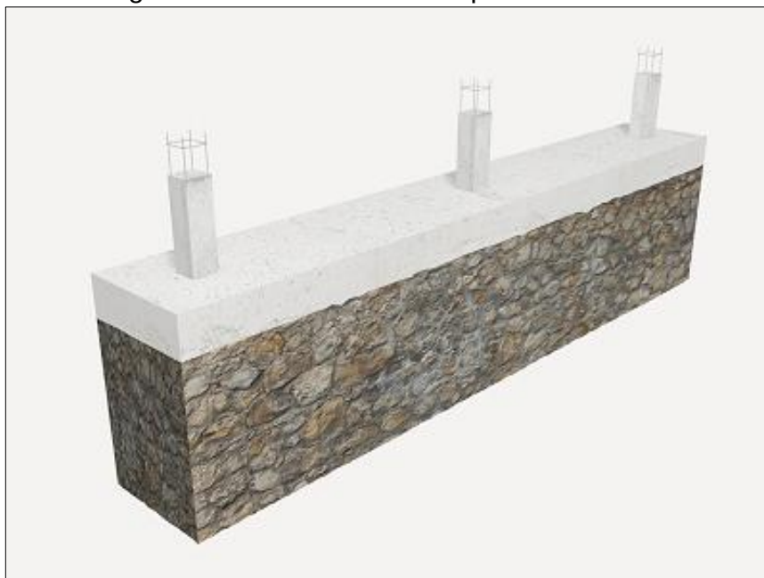
Figura 5.2 – Alvenaria sobre pedra marroada
