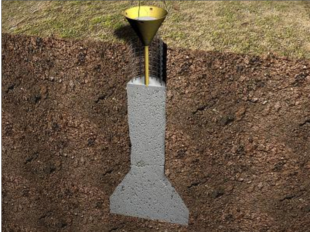
Figura 3.15 – Processo executivo de tubulão a céu aberto
