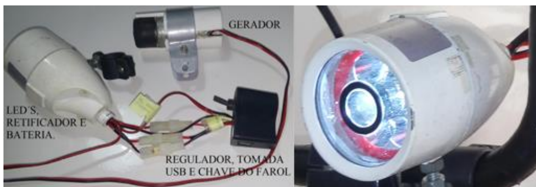
Foto 9. Sistema completo de geração de energia. (Autoria própria)
