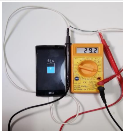
Foto 11. Ensaio de corrente no carregador original. (Autoria própria)
