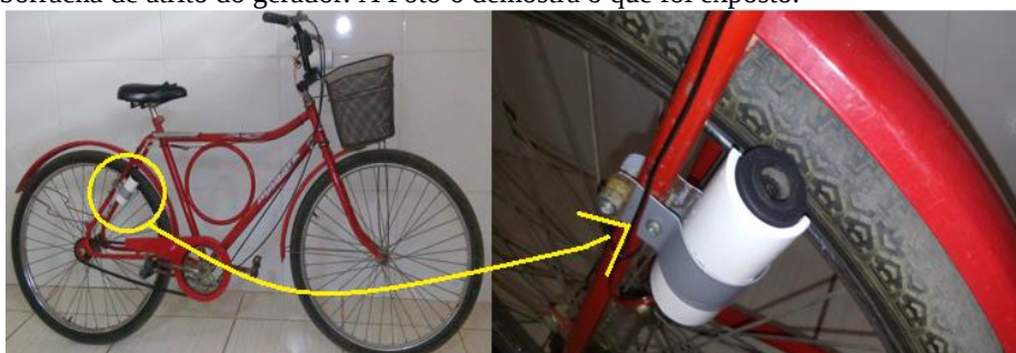
Foto 6. Gerador acoplado à bicicleta. (Autoria própria)
