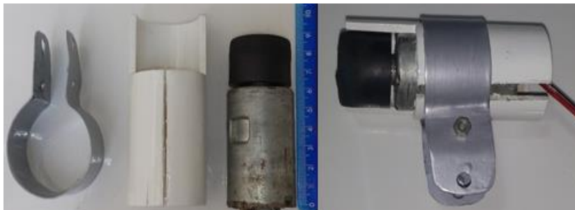
Foto 2. Gerador e seus componentes de fixação. (Autoria própria)
