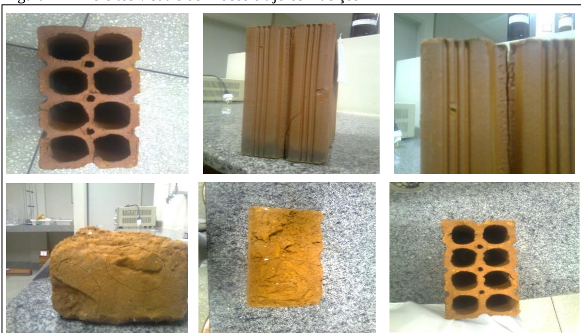
Figura 22 – Defeitos visuais de Blocos e tijolos maciços
