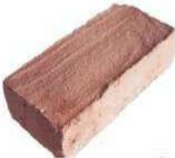
Figura 17 – Tijolo cerâmico com superfície irregular
