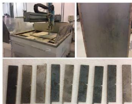
Figura 4. Máquina de corte jato d'água; Chapa de aço SAE 1010; Corpos de prova obtidos (1).
