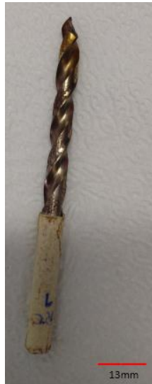
Figura 21 - Broca 1 revestida que sofreu ruptura
