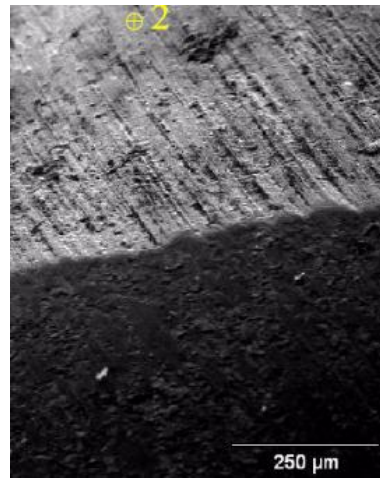
Figura 10 - Desgaste abrasivo numa broca helicoidal
