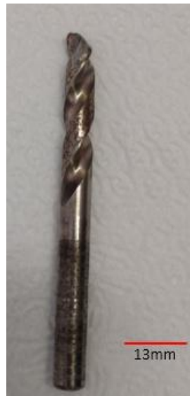
Figura 22 - Broca 2 revestida que sofreu ruptura
