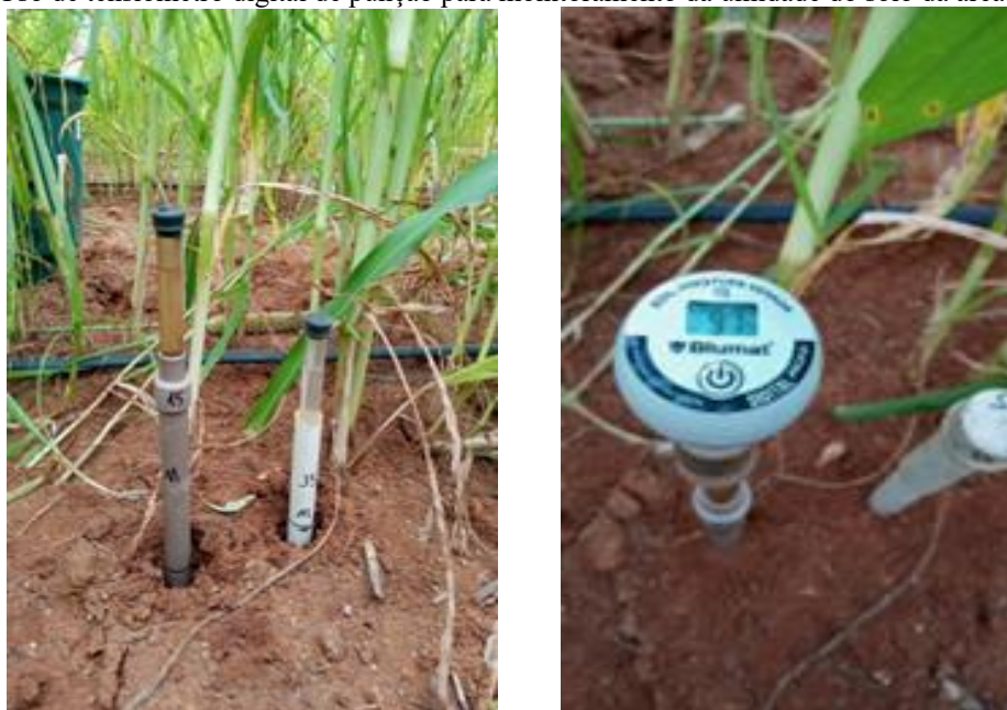
Figura 8 – Uso de tensiômetro digital de punção para monitoramento da umidade do solo da área experimental
