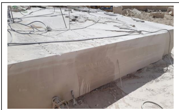
Figura 27: Fio diamantado e molhado
