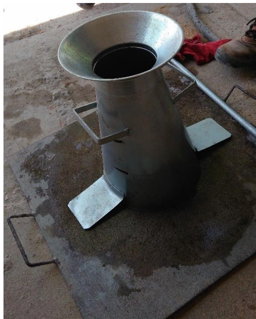
Figura 7 - Equipamentos utilizados para o Slump Test
