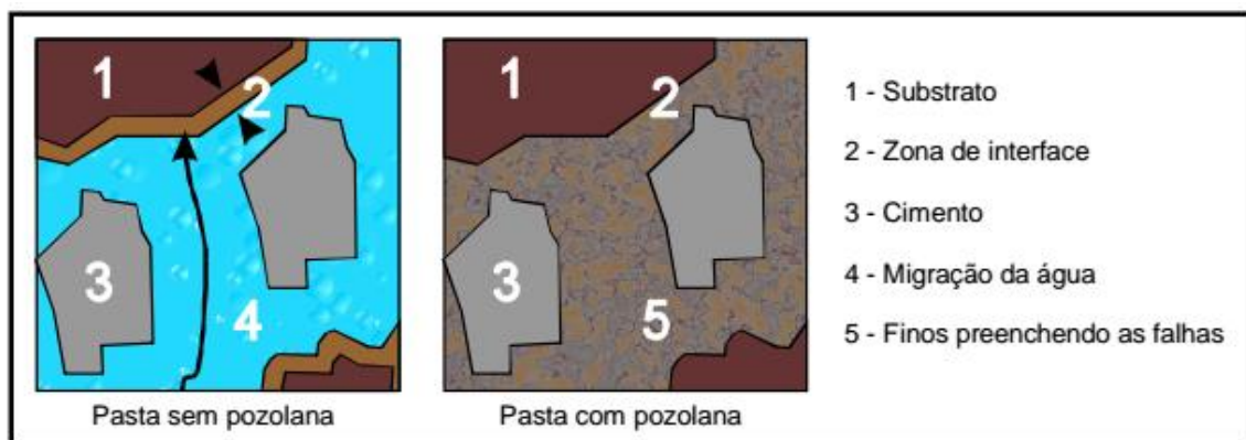
Figura 2 – Zona de interface pasta/agregado
