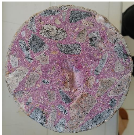
Figura 10- Ensaio de Carbonatação
