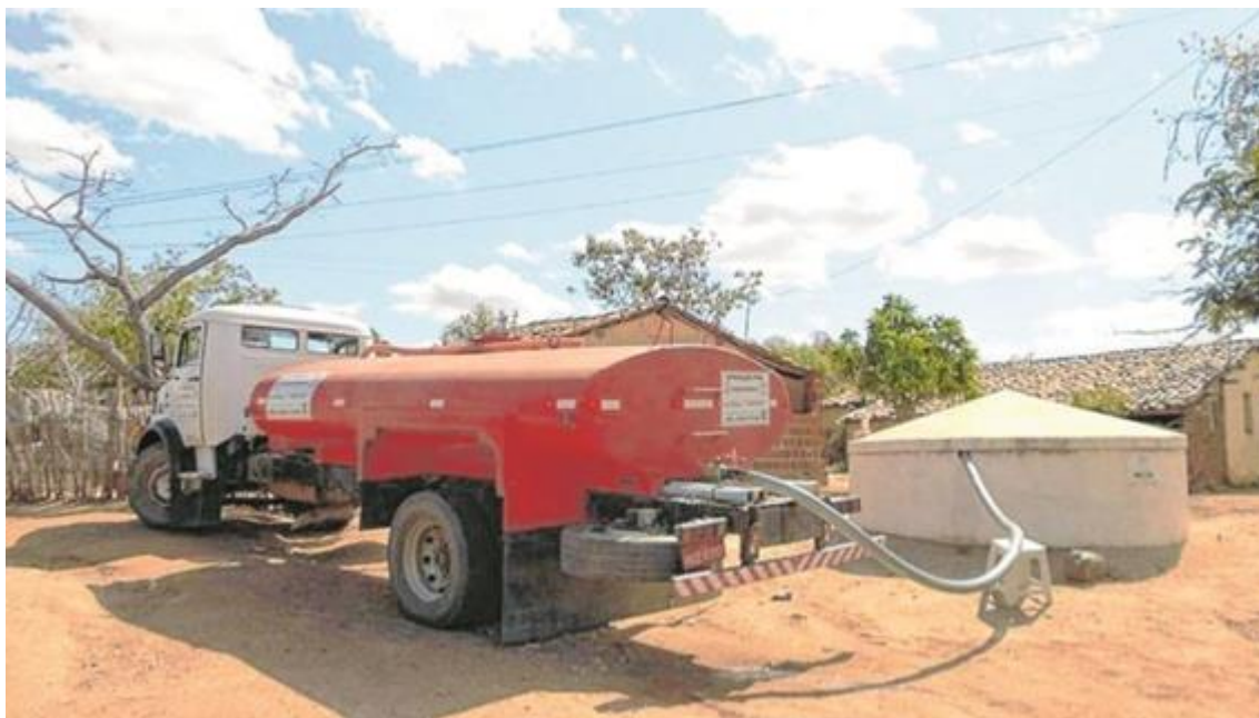
Figura 3 - Abastecimento da cisterna através do carro pipa.
