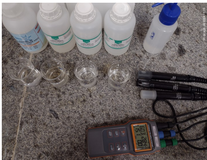
Figura 7 - Calibração do medidor multiparâmetro à prova d'água AK88.
