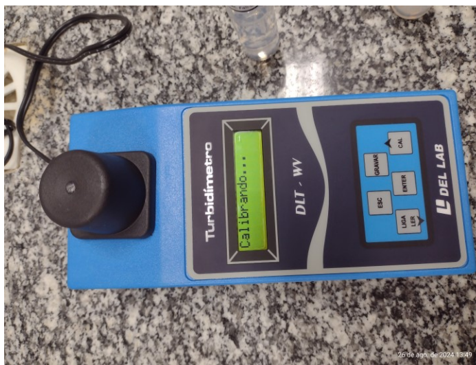
Figura 8 - Calibração do turbidímetro digital DLT-WV.
