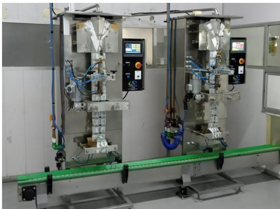
Figura 10. Máquinas envasadoras de polpa verticais
