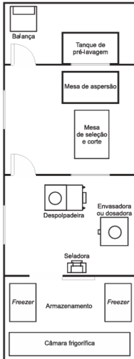
Figura 1. Exemplo de planta baixa de agroindústria de processamento de polpa de fruta congelada
