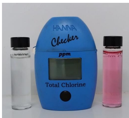
Figura 6: Equipamento para leitura de Cloro Residual.
